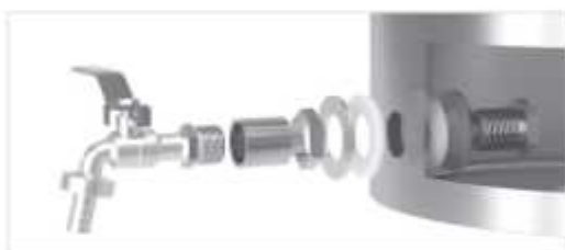
Схема сборки муфты сливного крана
